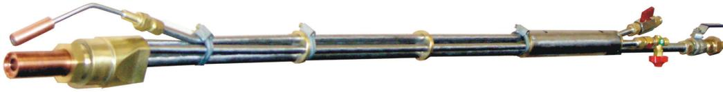
O maçarico **MCS** foi projetado para cortes pesados siderúrgicos, pátios de sucata e fundições. O maçarico utiliza bicos de corte do tipo mistura interna “nozzle mix” conhecidos como bicos de três sedes. Os gases de aquecimento, misturam-se no bico no interior de cada canal, bem próximo aos orifícios de saída.
